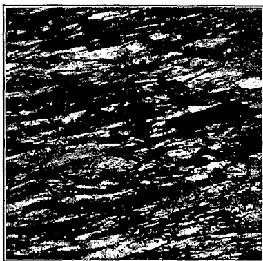
Фиг. 302. Микроскопическіе препараты изъ каррарскаго мрамора: вверху—до опыта, внизу—послѣ опыта (Эдемсъ и Никольсонъ).
